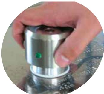
サワー・クリーン ハンディタイプ洗浄器はメタルマスクの洗浄を手軽に・簡単に行えます。
