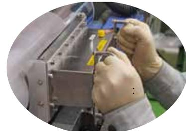
超音波を直接伝播させることにより、接着剤、インキ等が付着した各種ロールの洗浄を簡単に行えます。
